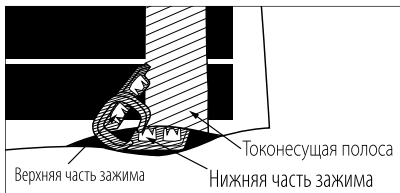
Нижняя часть зажима внутри медной токонесущей шины.
